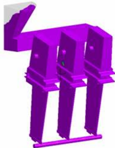
Porosity when alloy pour temperature is nominal
